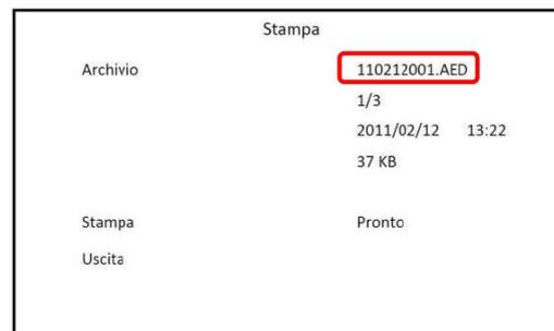
Ad ogni singolo file con estensione .AED corrisponde la registrazione dei dati di un singolo soccorso. E' possibile selezionare il file consultando le informazioni riportate direttamente sotto il suo nome (data ed ora inizio soccorso)
