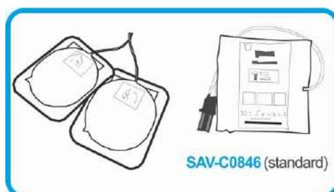
Le PADs **SAV-C0846** sono di tipo polarizzate, ovvero, il posizionamento degli elettrodi **non deve essere invertito**. Per maggiori informazioni sul posizionamento delle PADs di defibrillazione consultare il paragrafo relativo.
